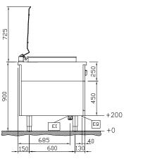
Drain ΕI Electrical inlet (power) EQ Equipotential screw Water inlet
